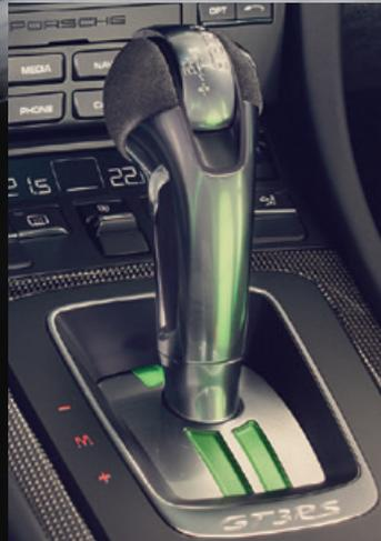
**KRAFTÜBERTRAGUNG:** performanceorientiertes 7-Gang Porsche Doppelkupplungsgetriebe (PDK) mit knackig-kurzer Getriebeübersetzung, kurzen Schaltzeiten und PDK SPORT Modus für extrem dynamische Schaltvorgänge.
